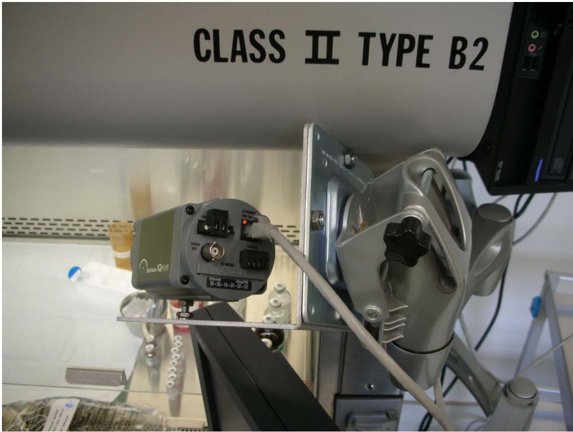
Figure 4. Illustration de l'installation de caméra au CHU Sainte-Justine. La caméra est située à environ 1 mètre de la zone de manipulation. Un support Ergotron® fixé à une barre métallique latérale attachée à l'enceinte permet de dégager rapidement la caméra de la hotte et de la repositionner à l'endroit désiré. Sous la caméra, on aperçoit l'écran plat qui permet la visualisation du flux vidéo et des images capturées par l'assistant-technique à partir d'une pédale USB (non illustrée).
